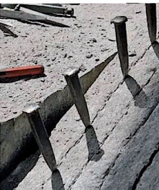
Spalten von Gneis zu Platten.
