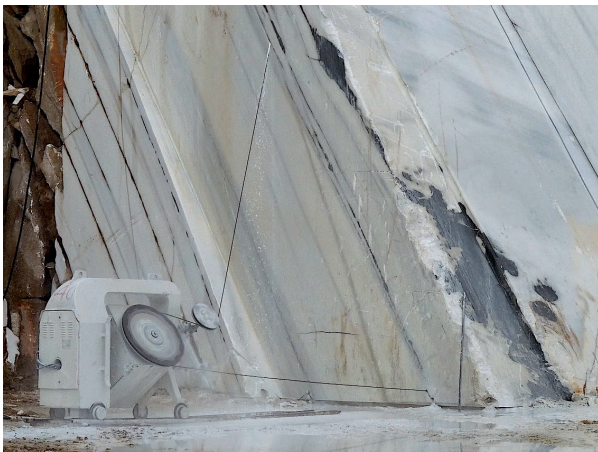
Beispiel einer Seilsäge auf Naxos (GR). Das Seil wurde vorgängig durch Bohrlöcher «eingefädelt».
