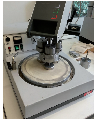
Polieren des Dünnschliffs (eingeklemmt unter den Stahlstempeln)
