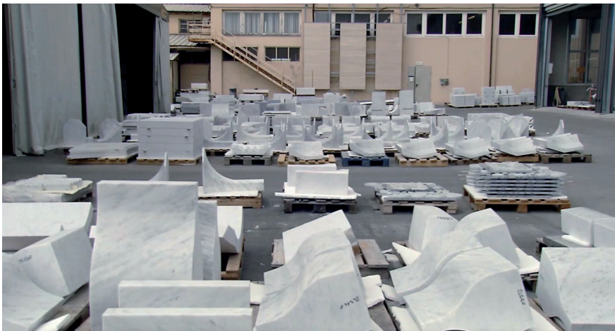
Mit einer computergesteuerten Kopierfräse vorgefertigte Bauteile und Kopierfräse
