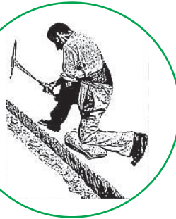
Schroten (Schlitze machen) mit einem Zweispitz.
