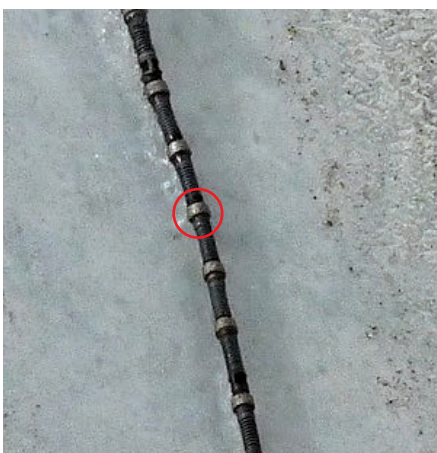
Stahlseil einer Seilsäge mit diamantbesetzten Segmenten (rot)
