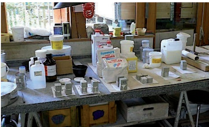
Um die richtigen Mörtelmischungen und Injektionsflüssigkeiten zu finden, wird in der Münsterbauhütte geforscht und „geprüft“.
