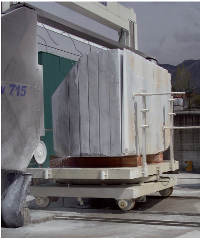
Zersägen eines Marmorblocks und fertige Marmorplatten
