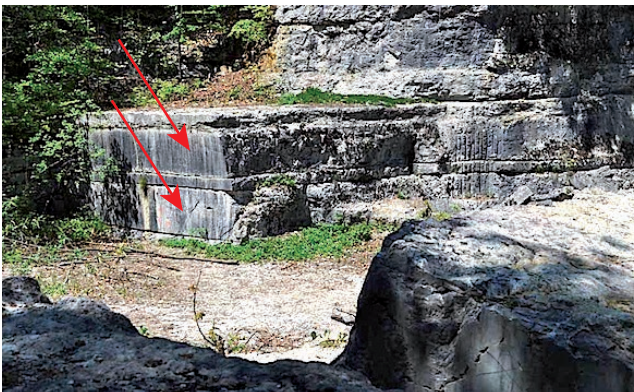
Dicke Schichten aus Kalkstein (Pfeile) in einem Steinbruch bei Solothurn, die ausschliesslich für die Herstellung von Brunnentrögen verwendet wurden.
