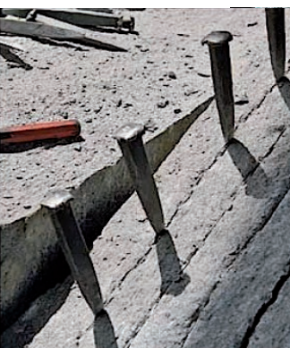
Spalten von Gneis zu Platten.
