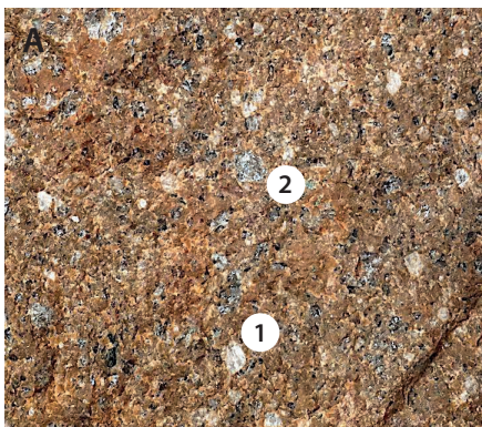
(A) Rhyolith mit weissen Feldspatkristallen (1) und transparenten Quarzkristallen (2). Dazwischen befindet sich eine mikrokristalline, «filzige» rötlich-braune Masse.
