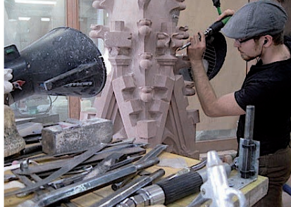
Steinmetze arbeiten bei der Herstellung von Ersatzsteinen mit modernen Elektrowerkzeugen ...
