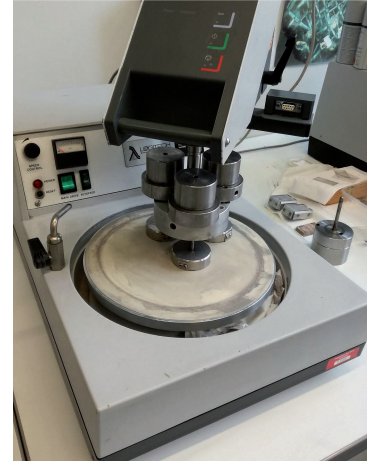
Polieren des Dünnschliffs (eingeklemmt unter den Stahlstempeln)
