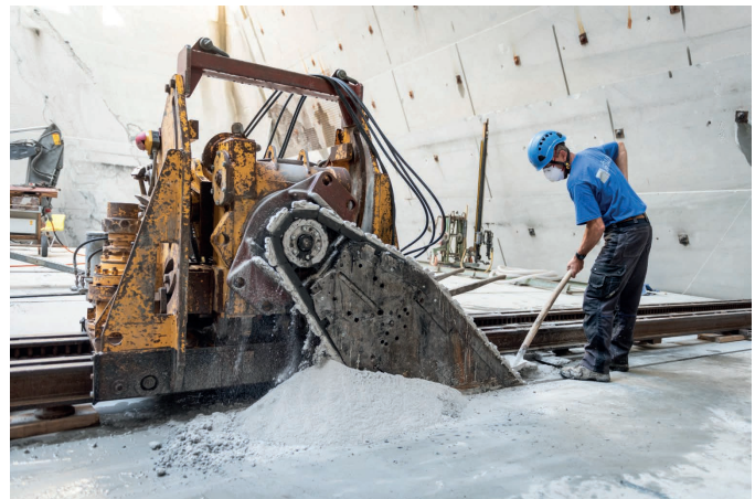
Beispiel einer Schwertsäge im Sandstein-Steinbruch Brand bei Eschenbach, ZH (Müller Natursteine AG)
