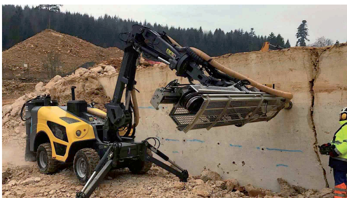
Heute werden die Blöcke des Laufener Kalksteins aus dem Fels gesägt.
