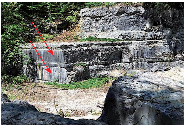
Dicke Schichten aus Kalkstein (Pfeile) in einem Steinbruch bei Solothurn, die ausschliesslich für die Herstellung von Brunnentrogen verwendet wurden.
