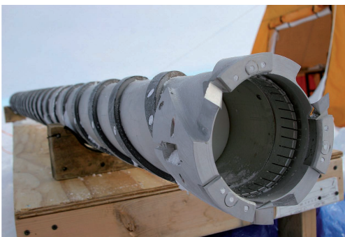
Hohlbohrer zum Erbohren von Eisbohrkernen.
