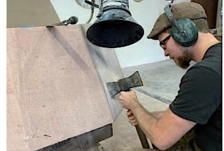
... aber auch mit traditionellem Handwerkzeug wie diesem Beil, wenn alte Oberflächenbearbeitungen nachgeahmt werden.
