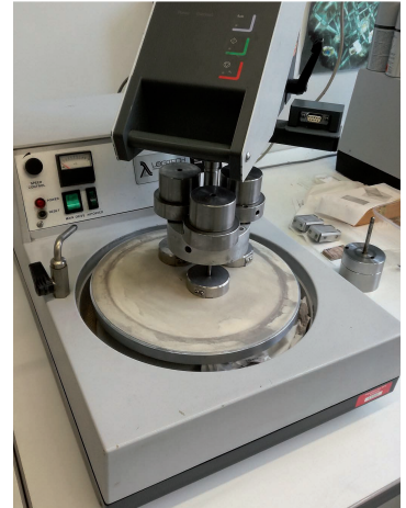
Polieren des Dünnschliffs (eingeklemmt unter den Stahlstempeln)
