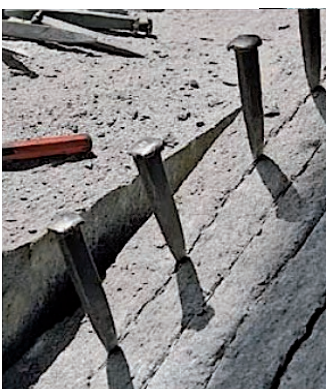
Spalten von Gneis zu Platten.
