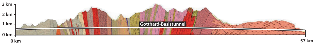
Profil durch die Zentralalpen mit dem Gotthard-Basistunnel. Der Tunnel liegt auf etwa 500 Meter über Meer, die höchsten Berge erreichen 3000 m. Die vorkommenden Gesteine sind mit unterschiedlichen Farben dargestellt.
