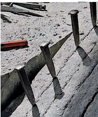
Abb. 3: Spalten von Gneis zu Platten
