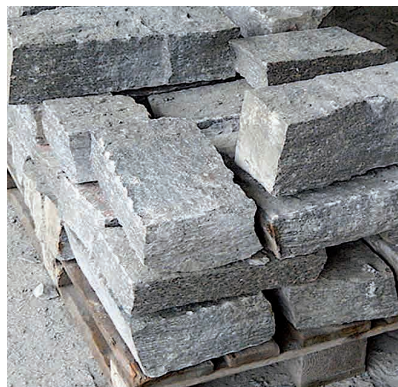
Abb. 4: Fertige Bausteine aus Gneis
