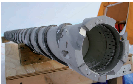
Abb. 20: Hohlbohrer zum Erbohren von Eisbohrkernen
