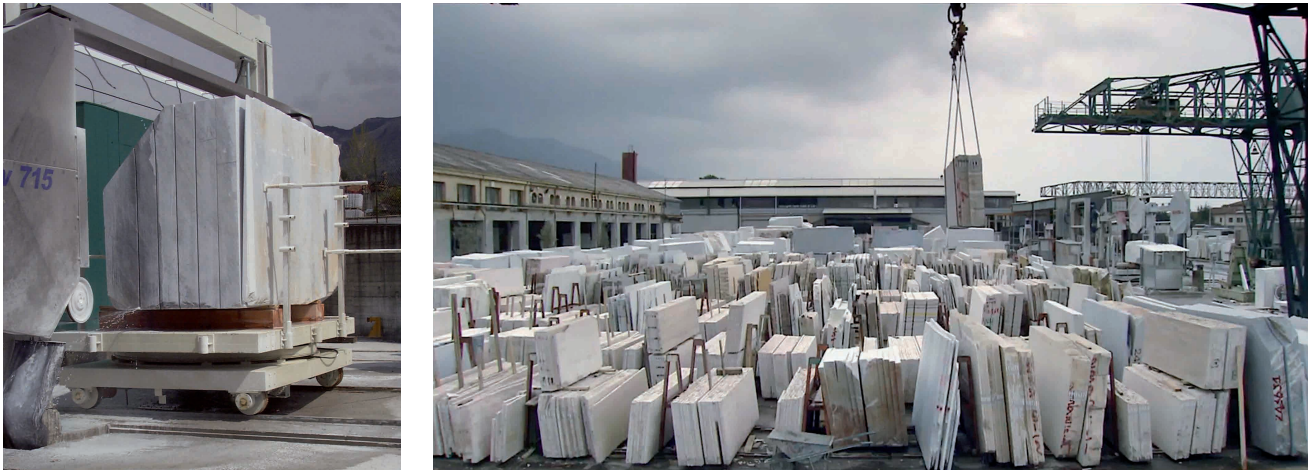
Abb. 20: Zersägen eines Marmorblocks und fertige Marmorplatten
