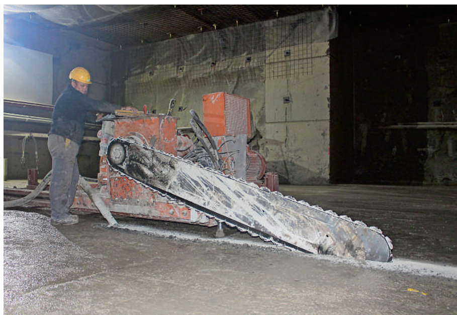
Die Diamantschwertsäge schrämt (sägt) im Steinbruch Leholz vertikale Schnitte in die Gesteinschicht.
