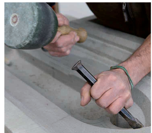
Abb. 14: Herstellung eines neuen Steins als Ersatz durch einen Steinmetz mit traditionellem Werkzeug.
