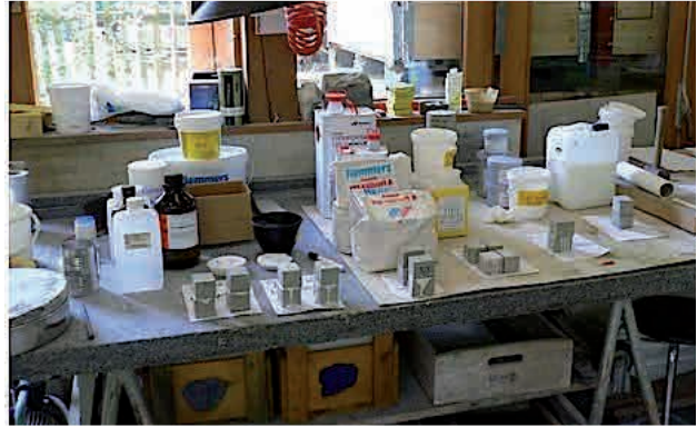
Abb. 16: Um die richtigen Mörtelmischungen und Injektionsflüssigkeiten zu finden, wird in der Münsterbauhütte geforscht und «geprübelt».
