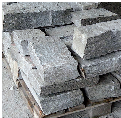
Abb. 4: Fertige Bausteine aus Gneis
