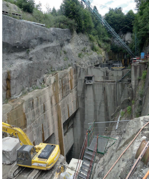
Abb. 17: Bis vor einigen Jahren wurde auch im Steinbruch Lehholz bei Bollingen im Schachtverfahren gearbeitet.
