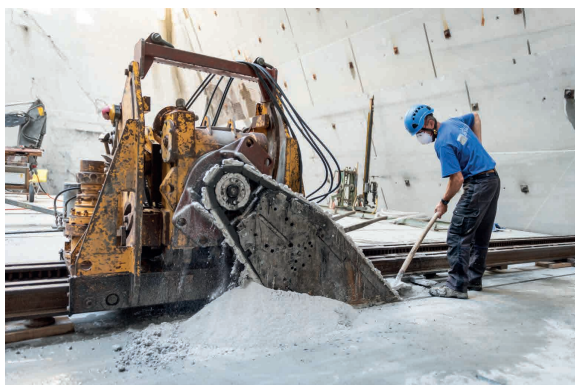
Abb. 16: Schwertsäge im Steinbruch Brand bei Eschenbach (Müller Natursteine AG)
