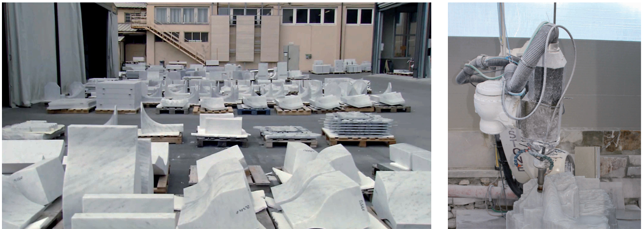
Abb. 21: Mit einer computergesteuerten Kopierfräse vorgefertigte Bauteile und Kopierfräse
