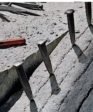
Abb. 3: Spalten von Gneis zu Platten
