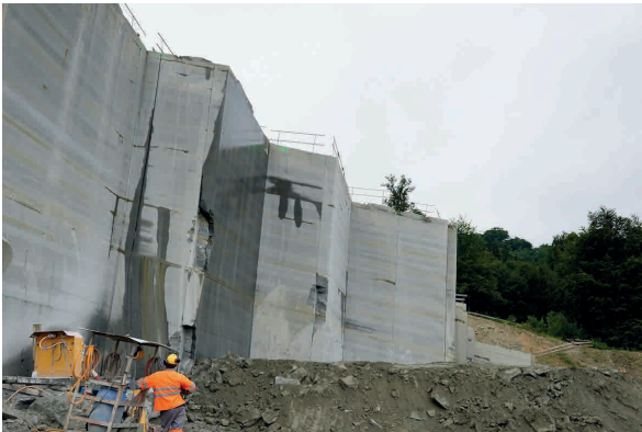
Abb. 12: Zerschneiden des Gesteins mit einer Seilsäge im Steinbruch Chreienwald. Das Seil wurde vorgängig durch Bohrlöcher «eingefädelt» und frisst sich nun – angetrieben von einem Motor – durch das Gestein, wobei eine fast ebene Schnittfläche entsteht.
