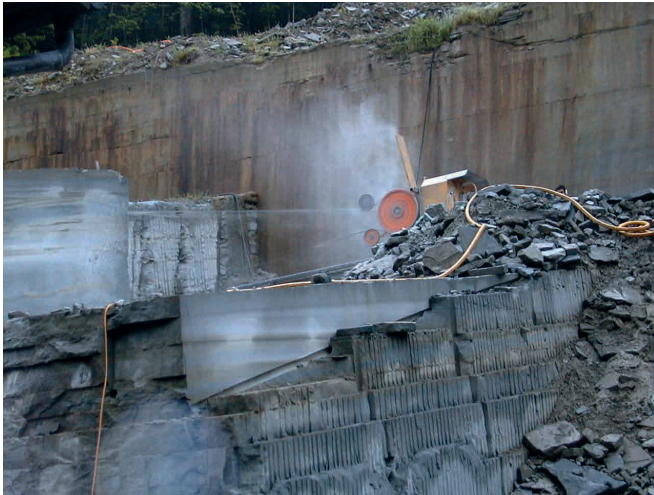
Abb. 12: Zerschneiden des Gesteins mit einer Seilsäge im Steinbruch Chreienwald. Das Seil wurde vorgängig durch Bohrlöcher «eingefädelt» und frisst sich nun – angetrieben von einem Motor – durch das Gestein, wobei eine fast ebene Schnittfläche entsteht.
