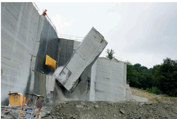
Abb. 14: Aktueller Abbau im Steinbruch Chreienwald. Dabei wird der Schlitz, den die Seilsäge hinterlassen hat, mit einem Kunststoffkissen, das mit Wasser gefüllt wird und sich dabei ausdehnt (gelb), aufgeweitet bis der Block auf einer schwachen, tonhaltigen Schicht abgleitet und auf eine Unterlage aus Schutt fällt, die den Sturz bremst. Dabei zerfällt der Block entlang von tonhaltigen Schichtflächen mit schwacher Haftung in kleinere Stücke, die leichter zu transportieren sind (Fotos Archiv Bärlocher AG).
