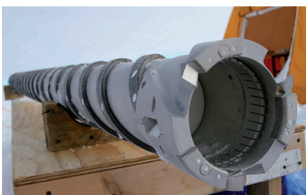
Abb. 20: Hohlbohrer zum Erbohren von Eisbohrkernen
