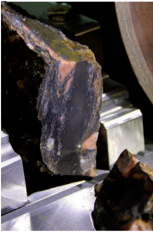
Sägen des Gesteins mit der Diamantsäge
