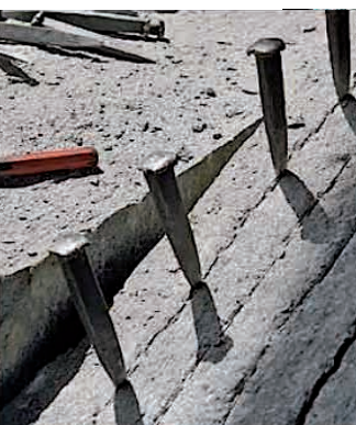
Abb. 3: Spalten von Gneis zu Platten
