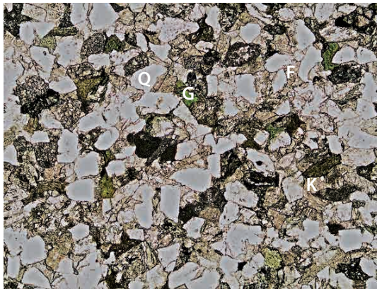
Abb. 19: Dünnschliff-Foto eines Sandsteins mit Körnern aus Quarz (Q), Feldspat (F) und Glaukonit (G) sowie mit Zement aus Kalzit (K), Vergrösserung ca. 20 x.
