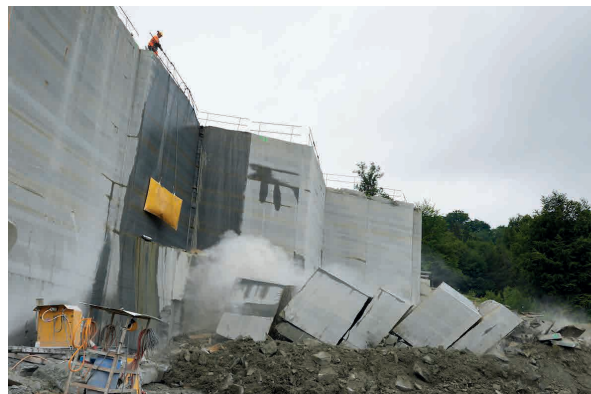
Abb. 14: Aktueller Abbau im Steinbruch Chreienwald. Dabei wird der Schlitz, den die Seilsäge hinterlassen hat, mit einem Kunststoffkissen, das mit Wasser gefüllt wird und sich dabei ausdehnt (gelb), aufgeweitet bis der Block auf einer schwachen, tonhaltigen Schicht abgleitet und auf eine Unterlage aus Schutt fällt, die den Sturz bremst. Dabei zerfällt der Block entlang von tonhaltigen Schichtflächen mit schwacher Haftung in kleinere Stücke, die leichter zu transportieren sind (Fotos Archiv Bärlocher AG).
