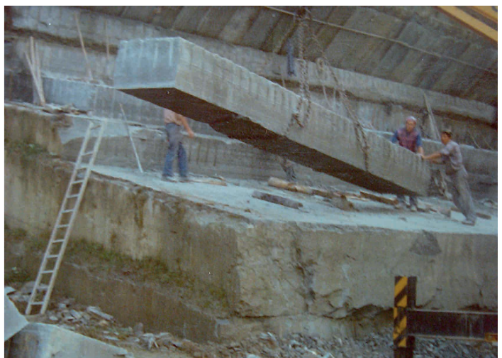
Abb. 6: Abbau mittels Bohrmaschine (auf Schienen, damit die Bohrlöcher genau in eine Linie zu liegen kommen) und Kran im Steinbruch Chreienwald; Transport der Steine mit Lastwagen und Eisenbahn (undatierte Fotos Archiv Bärlocher AG)
