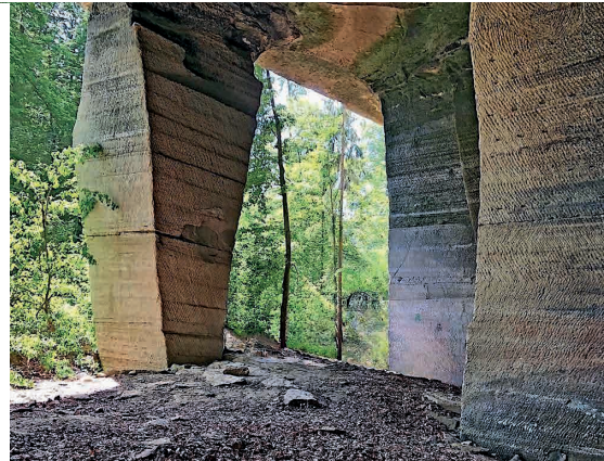
Abb. 8: Kavernen des aufgelassenen Steinbruchs Staffelsbach (AG) mit Spuren des Schrämens an den Wänden
