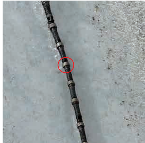
Abb. 13: Stahlseil einer Seilsäge mit diamantbesetzten Segmenten (rot), ca. 1 cm dick.
