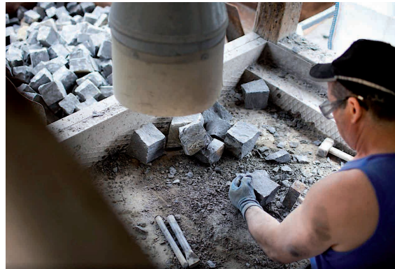
Abb. 5: Nachbearbeitung mit Hammer und Meissel
