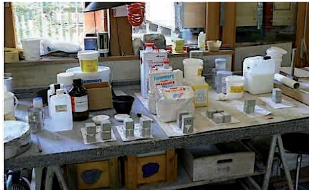
Abb. 17: Um die richtigen Mörtelmischungen und Injektionsflüssigkeiten zu finden, wird in der Münsterbauhütte geforscht und «geprübelt».
