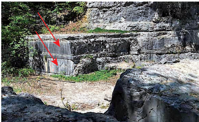
Abb. 2: Dicke Schichten aus Kalkstein (Pfeile) in einem Steinbruch bei Solothurn, die ausschliesslich für die Herstellung von Brunnentrögen verwendet wurden.
