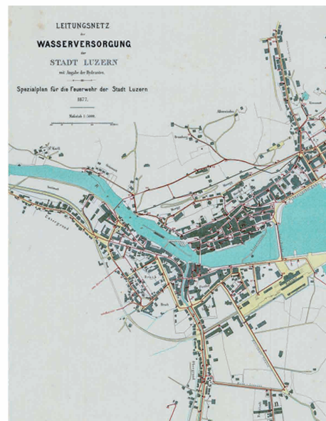
Das Druckleitungsnetz der Stadt Luzern kurz nach dessen Fertigstellung 1875. Präzise Erfassungen von Anschlüssen und Brunnen waren insbesondere für die Feuerwehr wichtig. Quelle: Stadtarchiv Luzern
