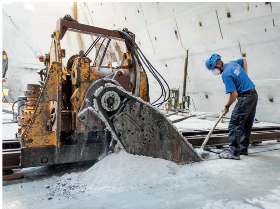
Abb. 16: Schwertsäge auf Schienen im Steinbruch Brand bei Eschenbach (Müller Natursteine AG), SG
