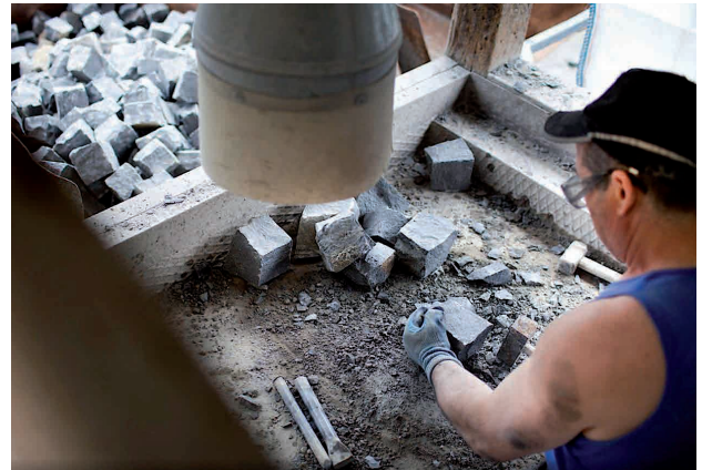
Abb. 5: Nachbearbeitung mit Hammer und Meissel
