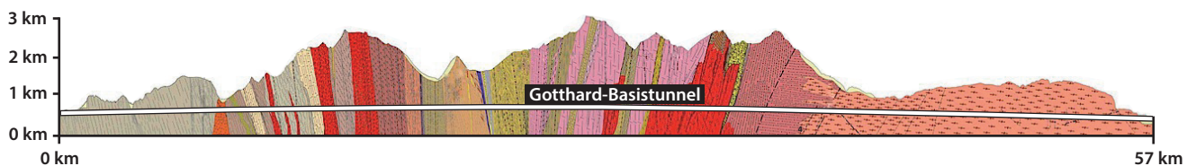
Abb. 6: Geologisches Profil durch die Zentralalpen mit dem Gotthard-Basistunnel. Der Tunnel liegt auf etwa 500 Meter über Meer, die höchsten Berge erreichen 3000 m. Die vorkommenden Gesteine sind mit unterschiedlichen Farben dargestellt.
