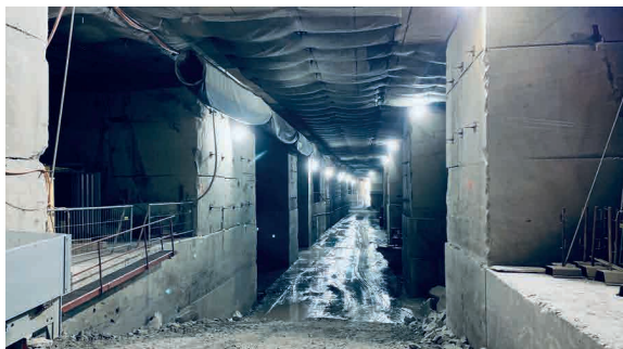
Abb. 17: Unterirdische Kaverne im Steinbruch Leholz bei Bollingen (SG). Vom Hauptgang aus werden auch seitliche Nischen abgebaut (Markus Arnitz, Linth24).
