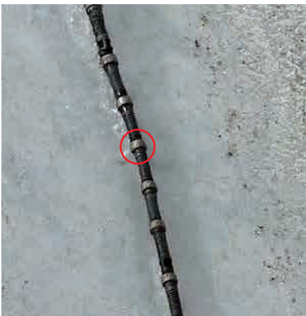
Abb. 16: Stahlseil einer Seilsäge mit diamantbesetzten Segmenten (rot)
