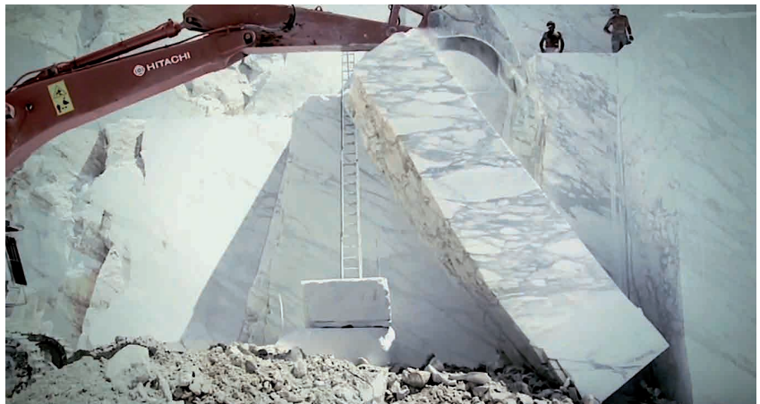
Abb. 17: Abbau gesägter Blöcke mit schweren Maschinen
