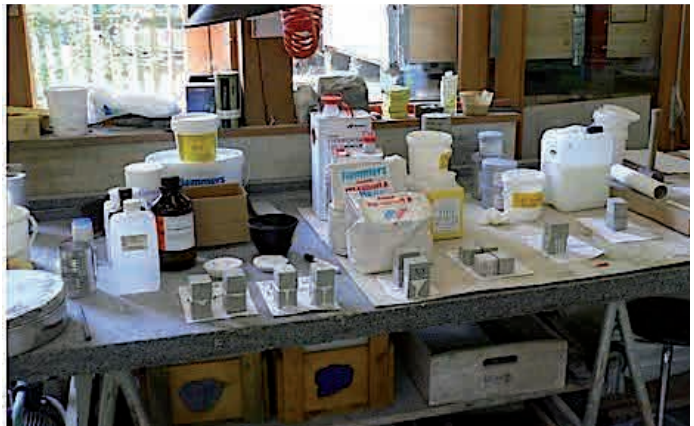
Abb. 24: Um die richtigen Mörtelmischungen und Injektionsflüssigkeiten zu finden, wird in der Münsterbauhütte geforscht und „geprübelt“.
