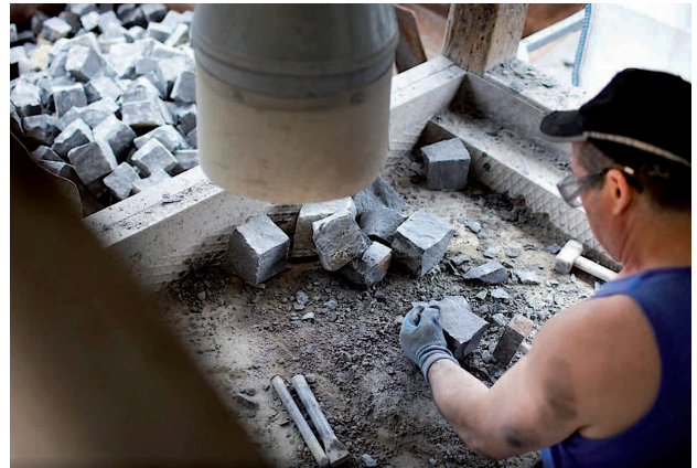
Abb. 5: Nachbearbeitung mit Hammer und Meissel
