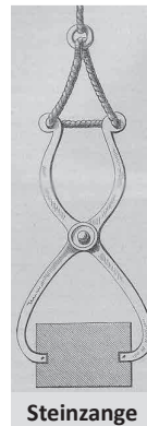
Abb. 7: Löcher in den Steinblöcken, in welche die Steinzange hineingreifen konnte. Diese werden deshalb Zangenlöcher genannt.
