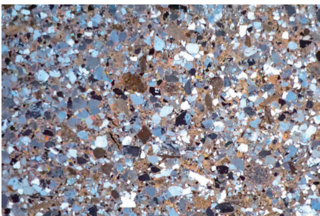
Abb. 2: Dünnschliff-Foto eines Gubersteins, Vergrösserung ca. 10 x. Es ist gut zu erkennen, dass die Quarz- und Feldspatkörner (weiss/grau/schwarz) von dicht gewachsenen Kalzitkristallen (braun) umgeben sind.
