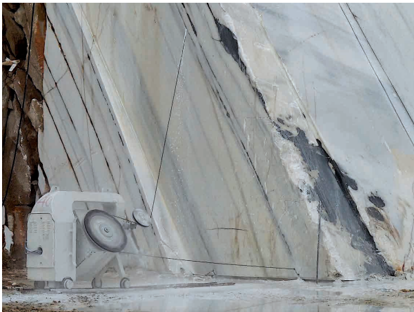
Abb. 14: Beispiel einer Seilsäge auf Naxos (GR). Das Seil wurde vorgängig durch Bohrlöcher «eingefädelt».
