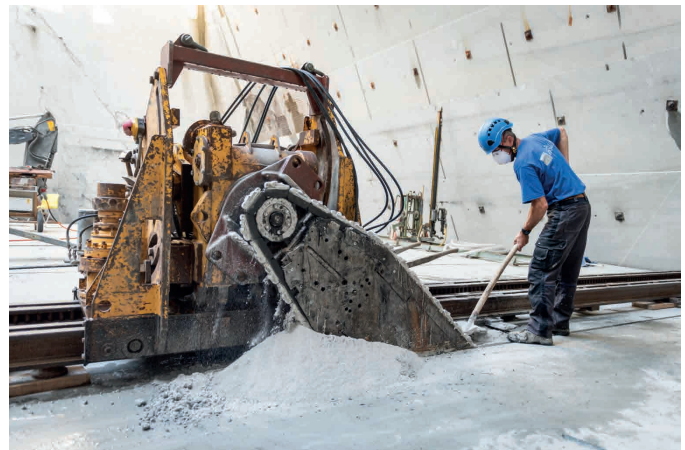
Abb. 15: Beispiel einer Schwertsäge im Sandstein-Steinbruch Brand bei Eschenbach, ZH (Müller Natursteine AG)
