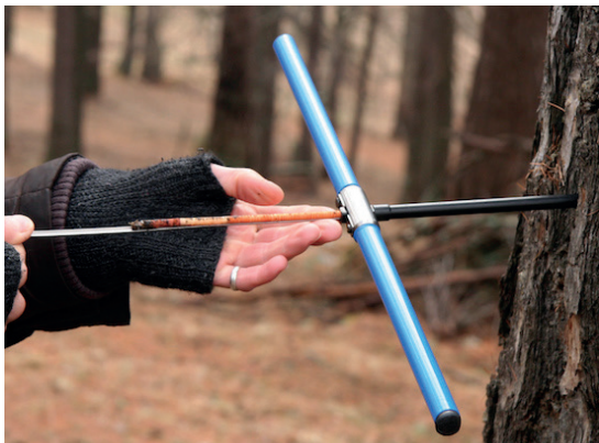
Abb. 7: Kernbohrer zur Beprobung des Jahrringmusters. Lebenden Bäumen wird dadurch kein bleibender Schaden zugefügt (Foto WSL).
