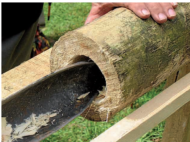
Abb. 7: Noch bis ins 20. Jahrhundert wurden hölzerne Teuchel vor allem in Berggebieten als Wasserleitungen genutzt. Hier wird demonstriert, wie ein Teuchel gebohrt wird.
