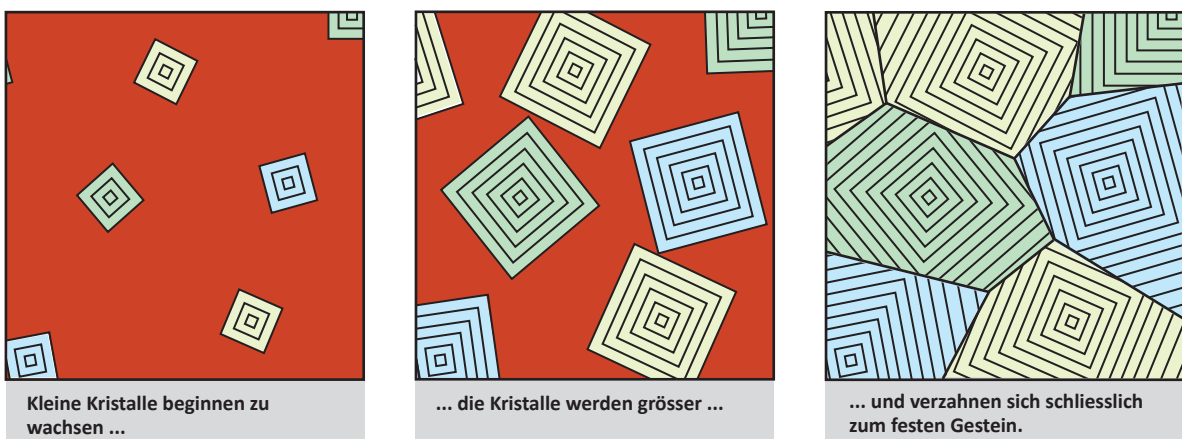
Abb. 4: Kristallwachstum in einer Schmelze (Magma) oder einer wässrigen Lösung bis zum festen Gestein
