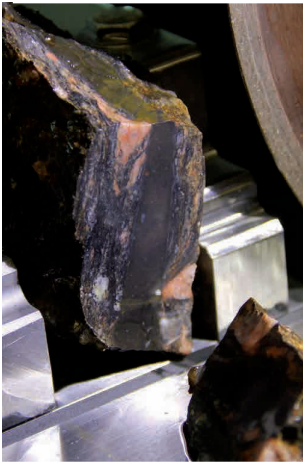
Sägen des Gesteins mit der Diamantsäge
