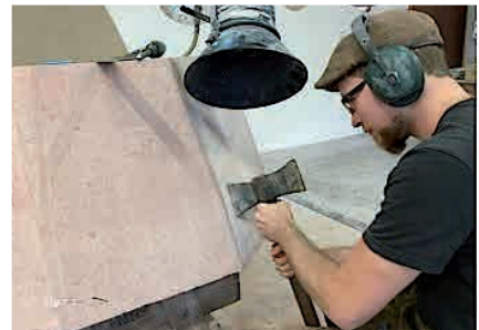
Abb. 30: ... aber auch mit traditionellem Handwerkzeug wie diesem Beil, wenn alte Oberflächenbearbeitungen nachgeahmt werden müssen.
