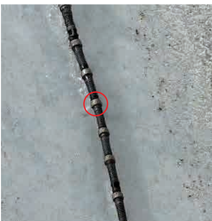
Abb. 16: Stahlseil einer Seilsäge mit diamantbesetzten Segmenten (rot)
