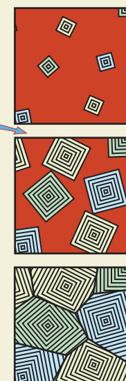
Abb. 8: Wenn glutflüssiges Magma granitischer Zusammensetzung unter 700°C abkühlt, beginnen Kristalle zu wachsen, die sich schliesslich ineinander verzahnen und festen Granit bilden. Dies dauert zehntausende bis hunderttausende Jahre.
