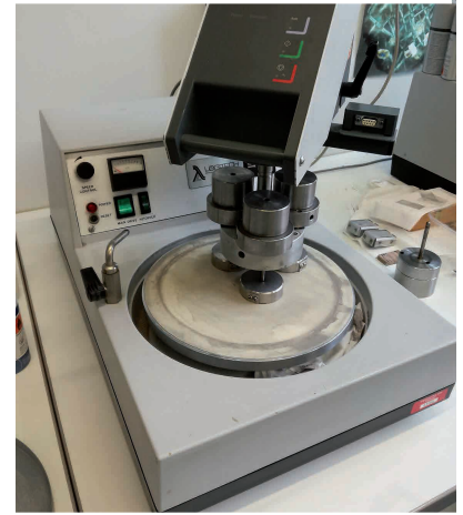
Abschleifen der Scheibe bis auf 30 Mikrometer und Polieren (eingeklemmt unter den Stahlstempeln)
