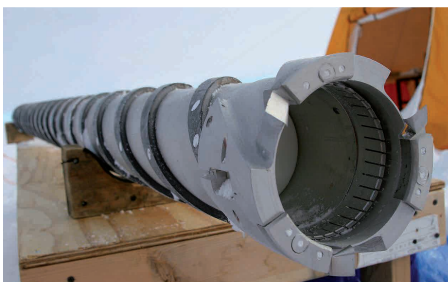
Abb. 20: Hohlbohrer zum Erbohren von Eisbohrkernen
