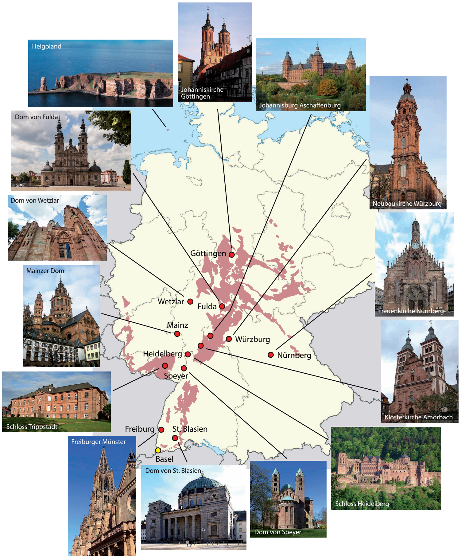
Abb. 18: Verbreitung des Buntsandsteins in Deutschland und einige Bauwerke aus Buntsandstein. In den rot eingefärbten Gebieten tritt Buntsandstein an die Erdoberfläche. Für Bauwerke ausserhalb dieser Gebiete musste der Buntsandstein teils über grosse Distanzen heran transportiert werden.
