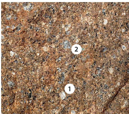
Abb. 6: Rhyolith mit weissen Feldspatkristallen (1) und transparenten Quarzkristallen (2). Dazwischen befindet sich eine mikrokristalline, «filzige» rötlich-braune Masse.
