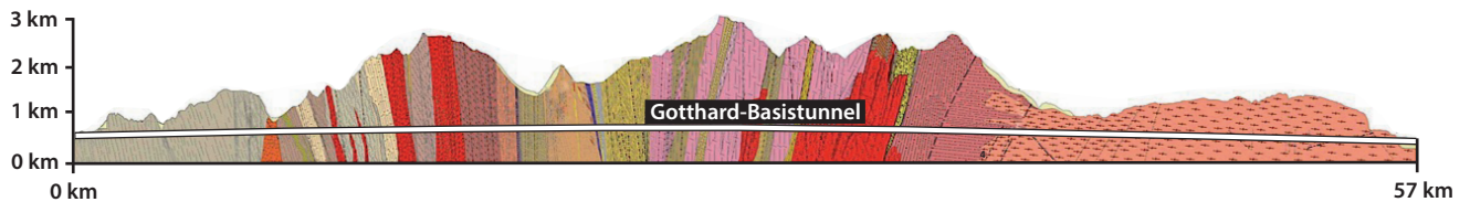
Abb. 6: Geologisches Profil durch die Zentralalpen mit dem Gotthard-Basistunnel. Der Tunnel liegt auf etwa 500 Meter über Meer, die höchsten Berge erreichen 3000 m. Die dort vorkommenden Gesteine sind mit unterschiedlichen Farben dargestellt.
