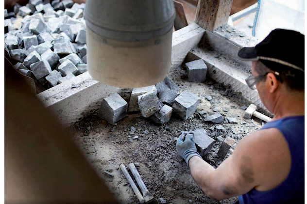
Abb. 5: Nachbearbeitung mit Hammer und Meissel
