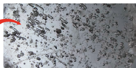
Abb. 20: In Eis eingeschlossene Luftblasen
