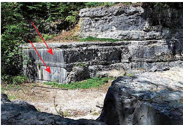
Abb. 2: Dicke Schichten aus Kalkstein (Pfeile) in einem Steinbruch bei Solothurn, die ausschliesslich für die Herstellung von Brunnen-trögen verwendet wurden.
