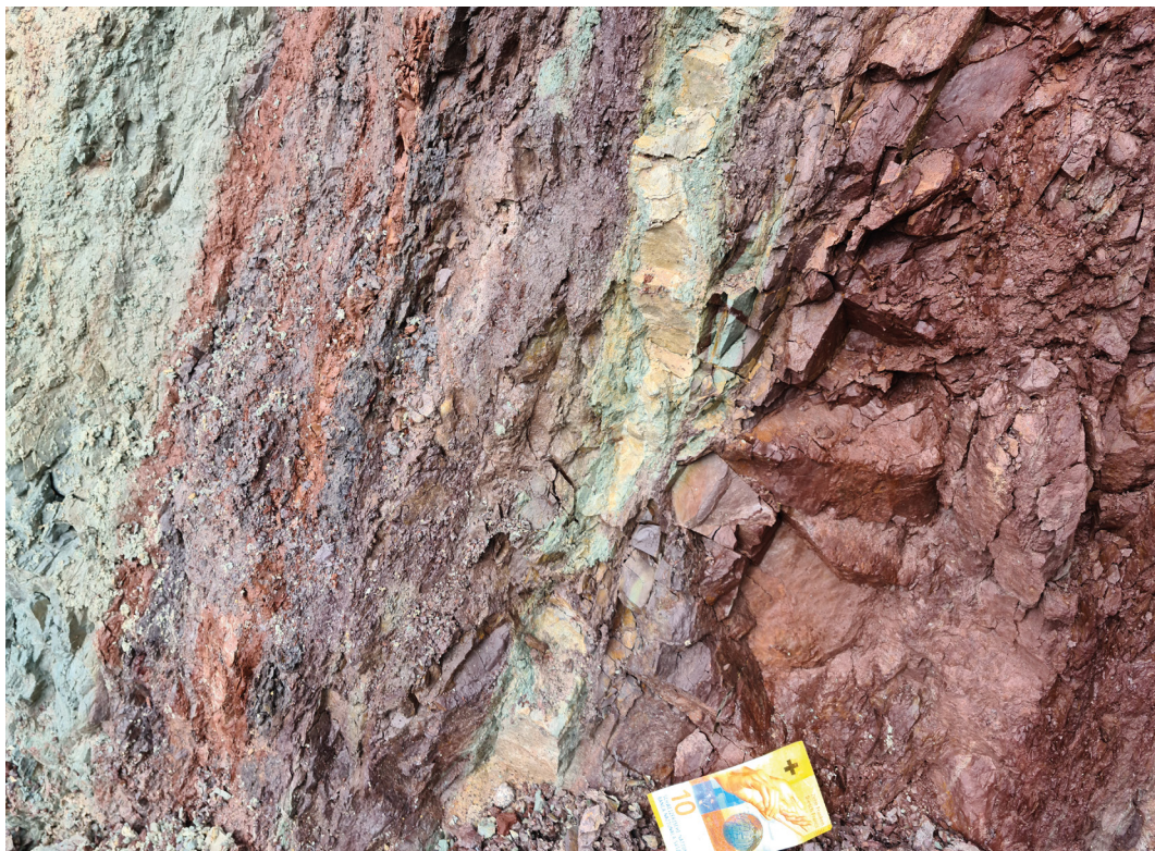
Fig. 3: Keuper-Aufschluss in Ennetbaden, 25 m nordöstlich des Limmatufers, zwischen Promenade und Umfahrungstunnel. Steilstehende «Obere Bunte Mergel» (heute: Gruhalde-Mb. der Klettgau-Fm.) im hochgedrückten Nordschenkel des Faltenkerns. Einfallen 330°/75°, Koord. 2°66'068/1°25'345.
