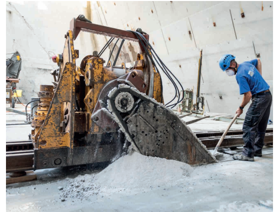
Abb. 6: Moderne Schwertsäge im Sandsteinbruch Brand bei Eschenbach (ZH), Müller Natursteine AG
