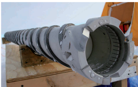
Abb. 17: Hohlbohrer zum Erbohren von Eisbohrkernen
